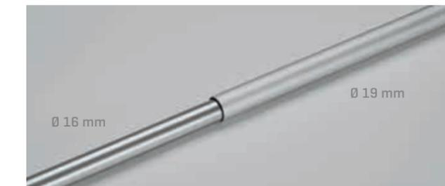
Einsatz als Distanzhülse für alle Ø 16 mm Rohre und Wellen. Positioniert die Klappeinlage präzise in der Endposition beim Verschieben. Damit wird ein zügiger und sicherer Prozessablauf beim Öffnen / Schließen der Klappeinlage erreicht. Vermeidung von Bedienungsfehlern.
